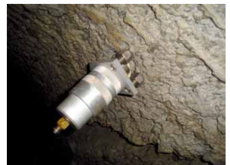
Prüfung der Oberflächenhaftzugfestigkeit.
