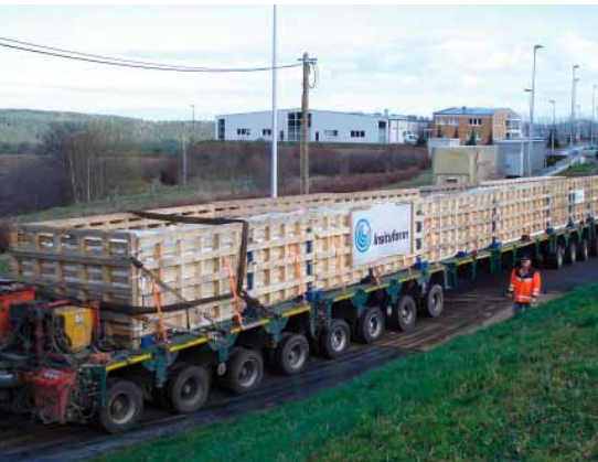
240-Tonnen-Schwertransport, 60 Meter lang, 16 Achsen.
