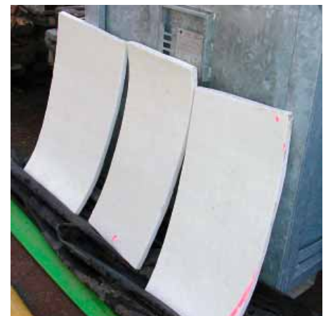
Frisch aus der Haltung: drei Linerproben von jeweils ca. 600 x 800 mm.
