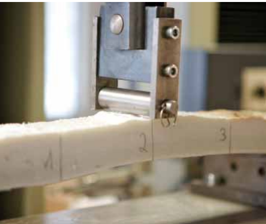
Drei-Punkt-Biegeversuch an Großliner von Insituform.
