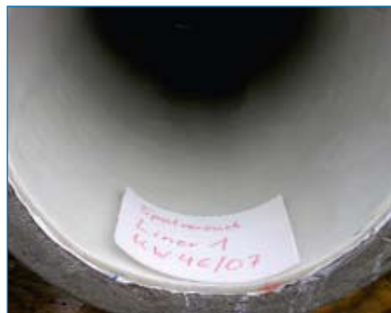
Hochdruckpülversuch nach DIN 19523: Praxisprüfung, IRT Geschwenda, Bild rechts unten: Abriebversuch Kippbinne nach DIN EN 295-3, Ingenieurbüro Siebert und Knipschild
