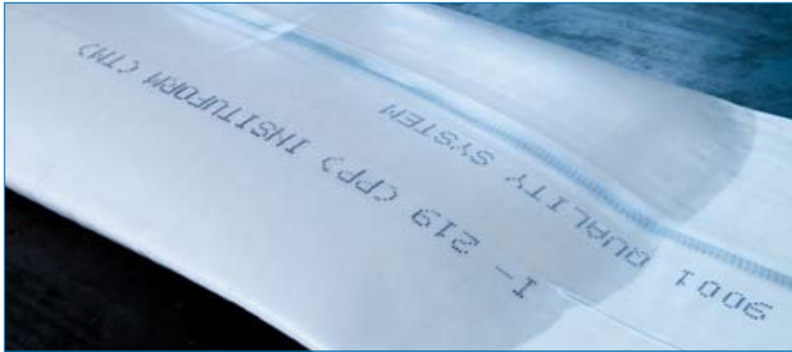
Imprägnierung eines Insituform-Schlauchliners
